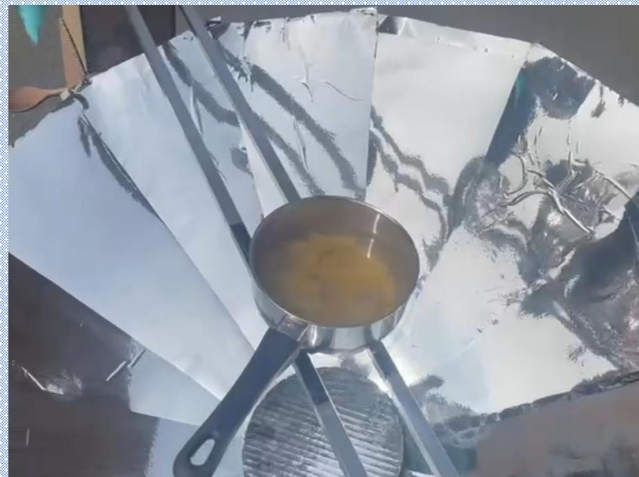
Ecco la nostra cucina solare: la pentola è posizionata in prossimità del fuoco della superficie parabolica
